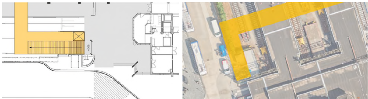
Figuur 47 Aanlanding tijdelijke traverse aan stadszijde
